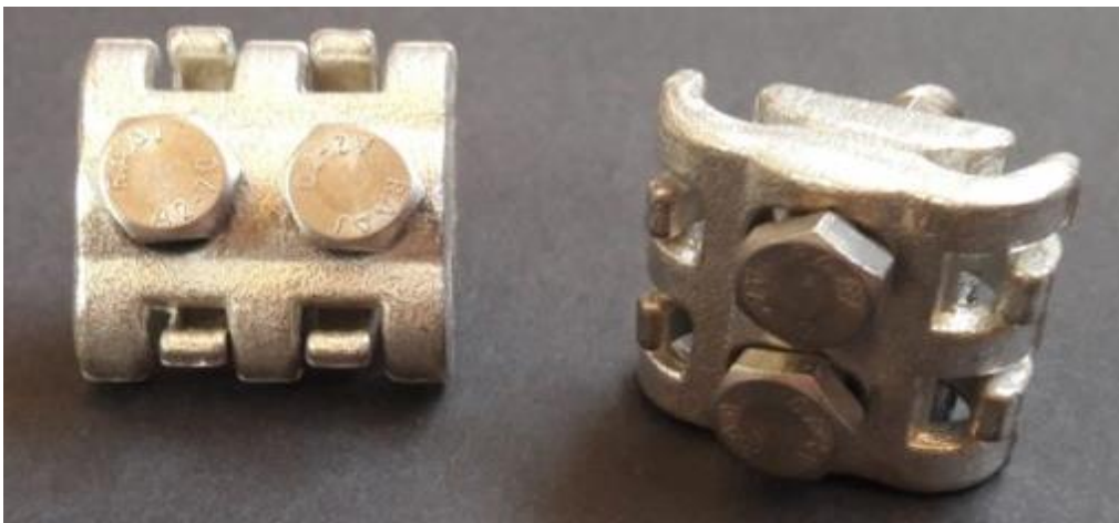
Figure 11: Raccord à griffes en laiton étamé pour conducteurs de 10 à 50mm 2 visserie EZ
